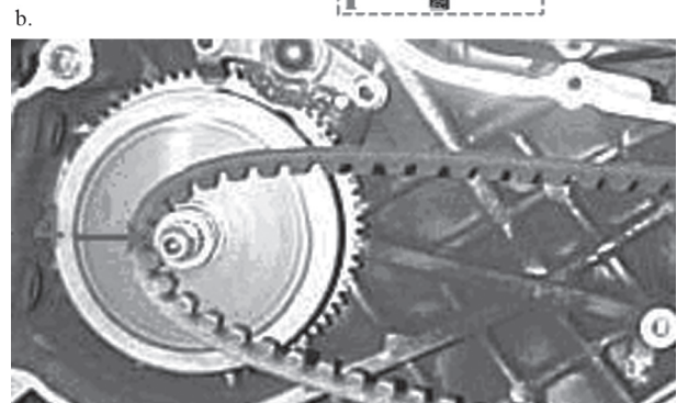
2 pav. Ribotuvus motorolerio variatoriuje. a – variatoriaus schema; b – ribotuvo montavimas; 1 – sankaba; 2 – variatorius; 3 – reduktorius; 4 – ribotuvo žiedas.
