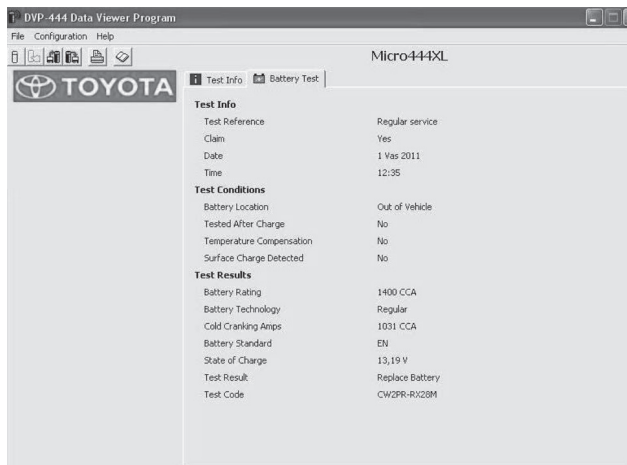
3 pav. Visiškai įkrautos akumuliatorių baterijos paleidimo (starterinės) srovės matavimo testas.
