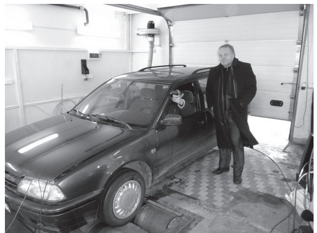
11 pav. Automobilio su HHO dujų generatoriumi stendiniai bandymai
