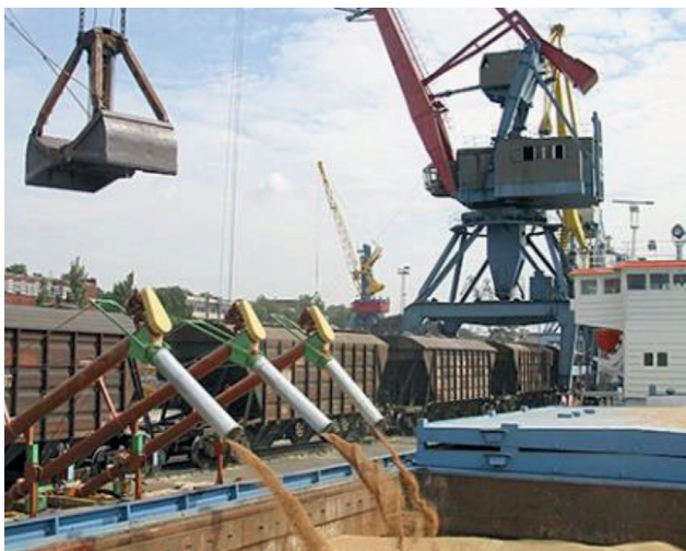
7 pav. Grūdų perkrovimas iš vagonų į laivą
