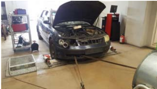
2 pav. Automobilio traukos stende CARTEC LPS 2510 bandomas automobilis
