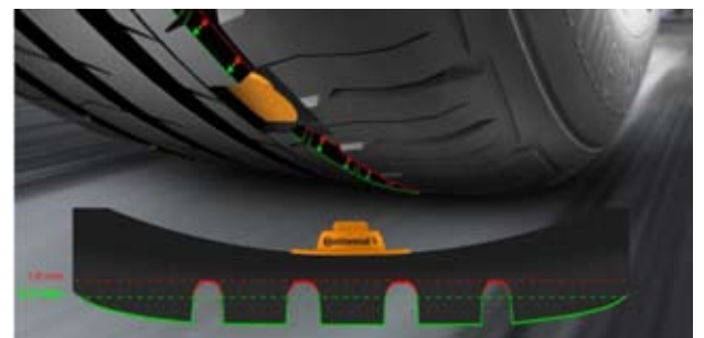
2 pav. Continental padangos slėgio ir protektoriaus gylio stebėsenos sistema [4]
