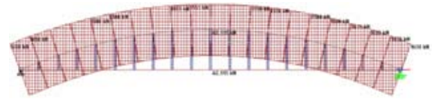
4 pav. Ašinių jėgų pasiskirstymas tradicinės arkinės perdangos elementuose
