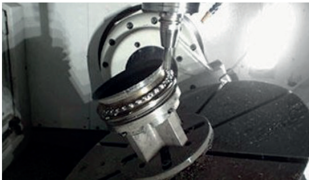
12 pav. Gaminio frezavimas po spausdinimo Šaltinis: www.tongtai.com
