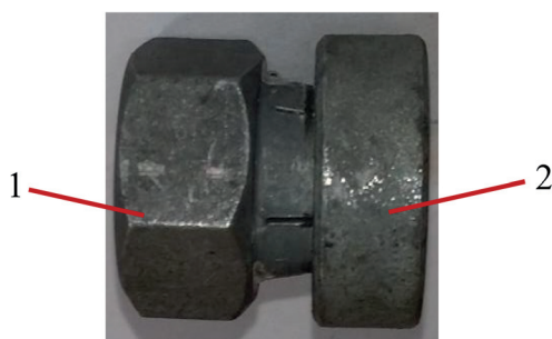
2 pav. Specialios konstrukcijos veržlės M10x1 bendro vaizdo nuotrauka
